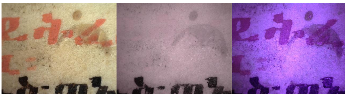
Fig. 14. Particolare del testo di scrittura (c. 3ra) esaminato con microscopio Dino-Lite nello spettro del visibile (a sinistra), dell'infrarosso (al centro) e dell'ultravioletto (a destra).
